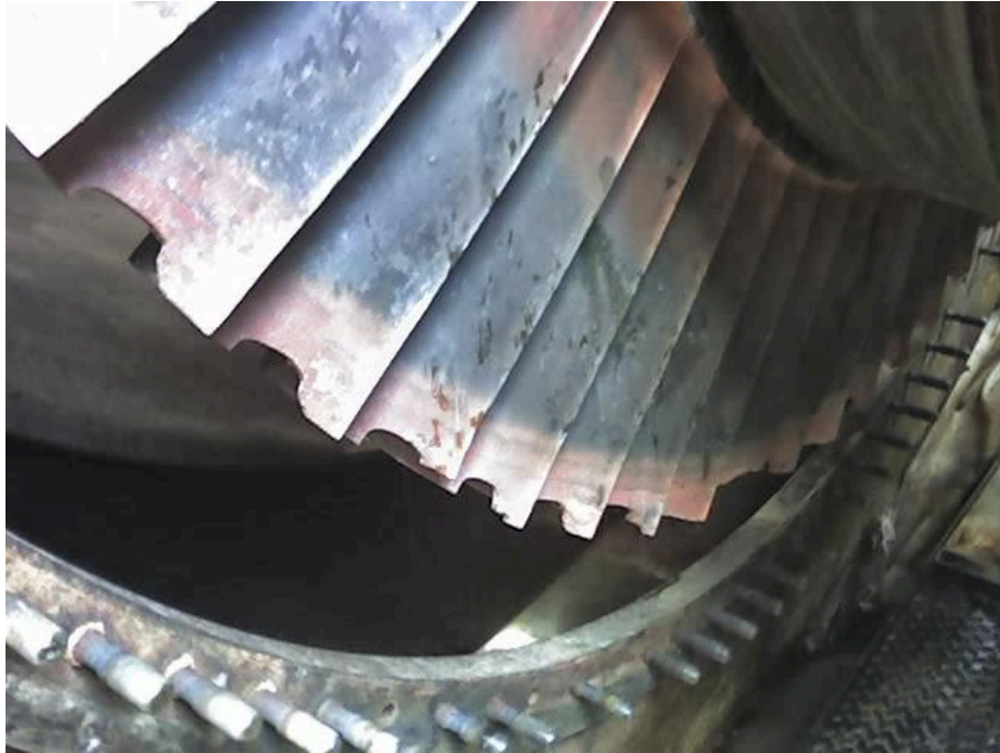
Figura 2. Foto de uma pá de turbina danificada por deposição de particulado seguida de encharcamento de calor.
