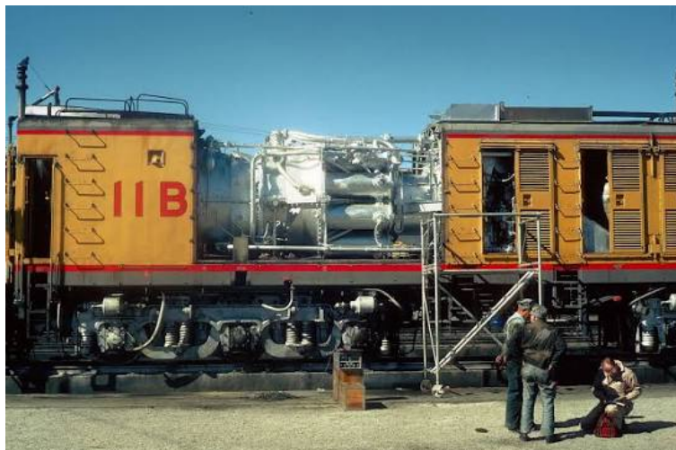
Figura 2 - Foto de uma locomotiva "Big Blow" da Union Pacific mostrando a turbina a gás.
