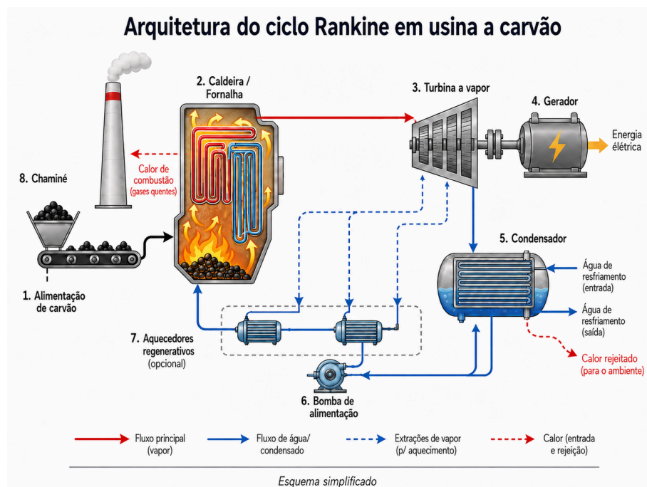
Figura 2 — Esquema simplificado de uma usina a carvão baseada no ciclo Rankine. A água e o vapor circulam no interior dos tubos da caldeira, enquanto os gases quentes da combustão circulam externamente aos tubos.
